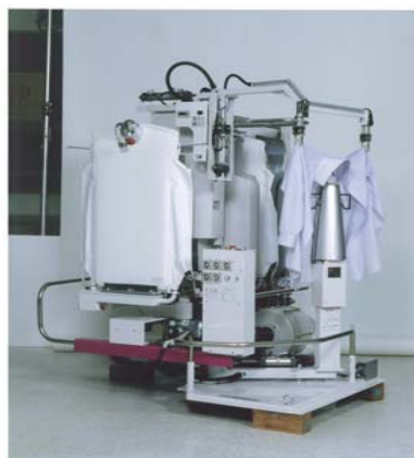
シャツ用ボディープレス機 (Wタイプ・オートキャリー付)
