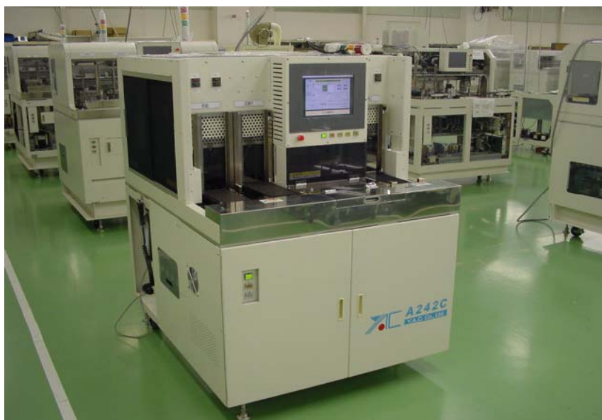
ICテストハンドラー(4個同時測定・常温タイプ)
